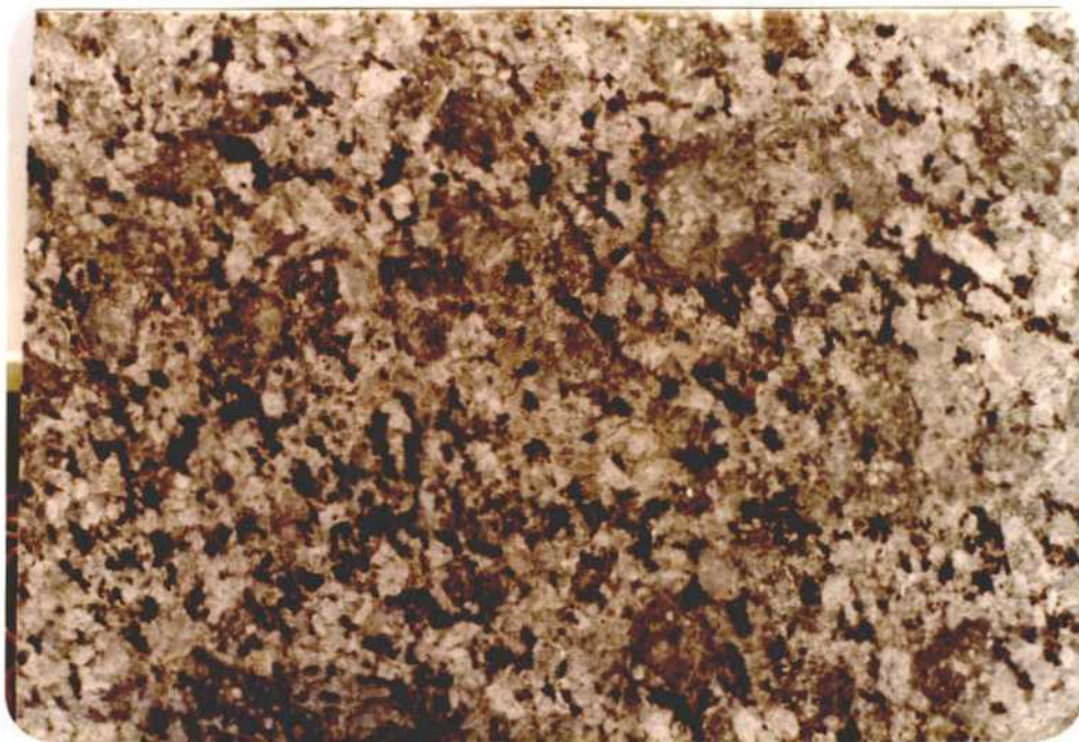
Fotografía de una plaqueta pulida. El verdadero color del granito es gris-azulado.
