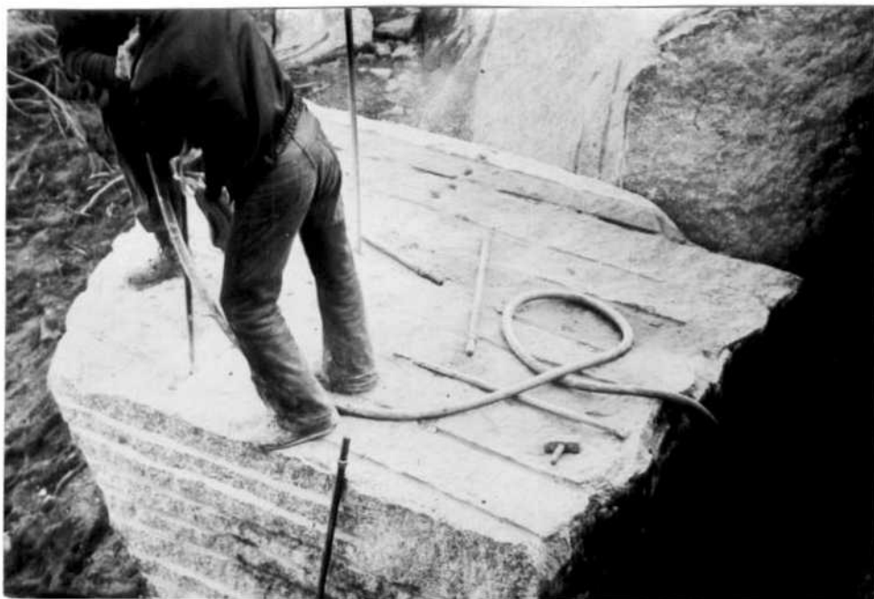
Extracción del bloque con medidas comerciales en la calicata C-12.
